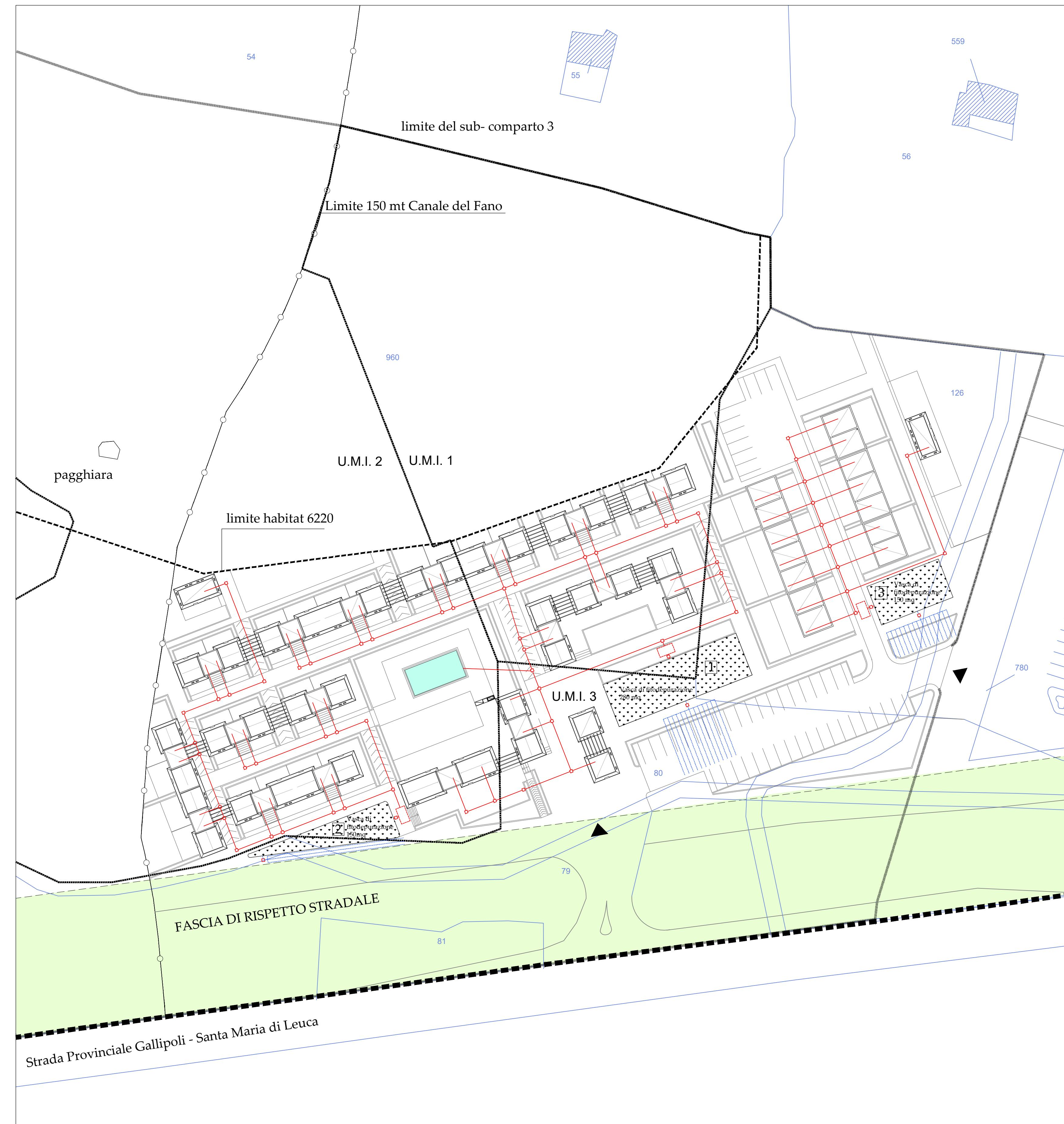
PLANIMETRIA GENERALE CON INDICAZIONE DEGLI IMPIANTI DI FITODEPURAZIONE CON SUB - IRRIGAZIONE - scala 1: 500
