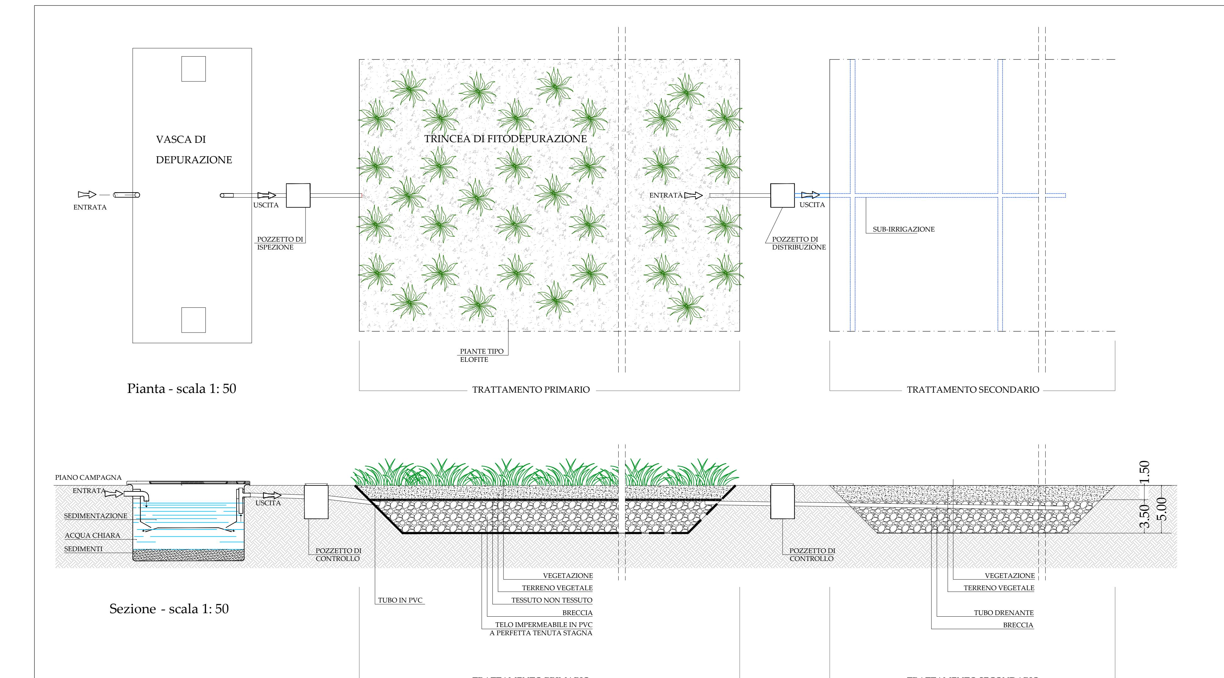
SCHEMA TIPOLOGICO FITODEPURAZIONE CON SUB - IRRIGAZIONE
